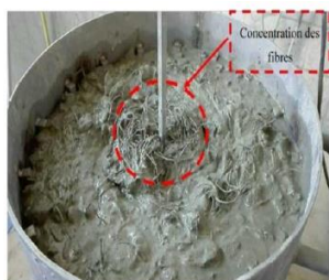
Concentration des PPF de 54mm autour de la pale au moment de l'essai.
