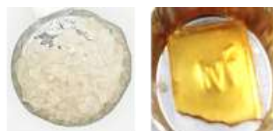
Réseaux de PDMS (gauche) sans et (droite) avec 7,6wt% de motif pyromellitidiimide après 1000h à 250°C
